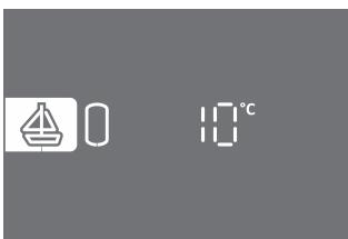
**V primeru onemogočenega grela (parameter 01:09) se minimalna temperatura vzdržuje le z delovanjem toplotne črpalke. V primeru temperature izvora izven območja delovanja toplotne črpalke zaščita pred zmrzovanjem ne bo delovala!**
