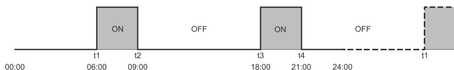
Slika 13: Primer nastavitve časovnika - ogrevanje radiatorja
